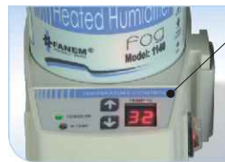
Umidificador FOG® 1140 Indicador digital da temperatura e 10 níveis de aquecimento
